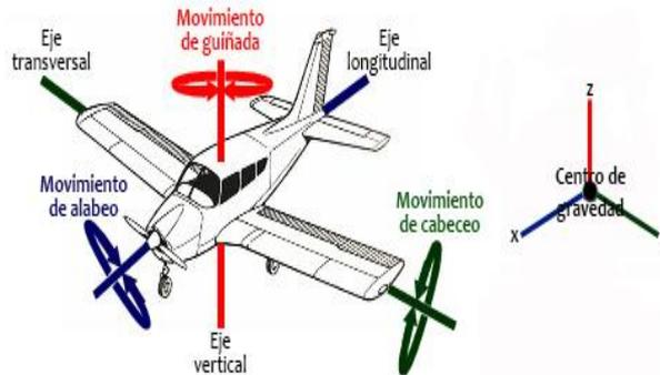
Figura 26. Ejemplo de rotación usando Ángulos de Euler
