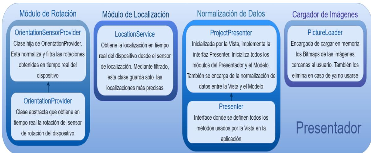
Figura 10. Esquema de las clases creadas para el Presentador de la aplicación
