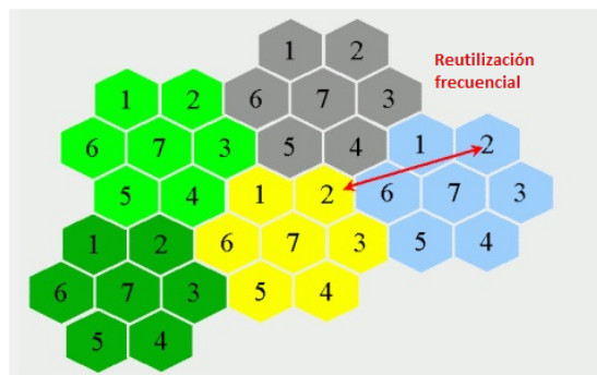
Figura 2.1: Modelo tradicional de reutilización de frecuencias en sistemas celulares con un factor K=7
