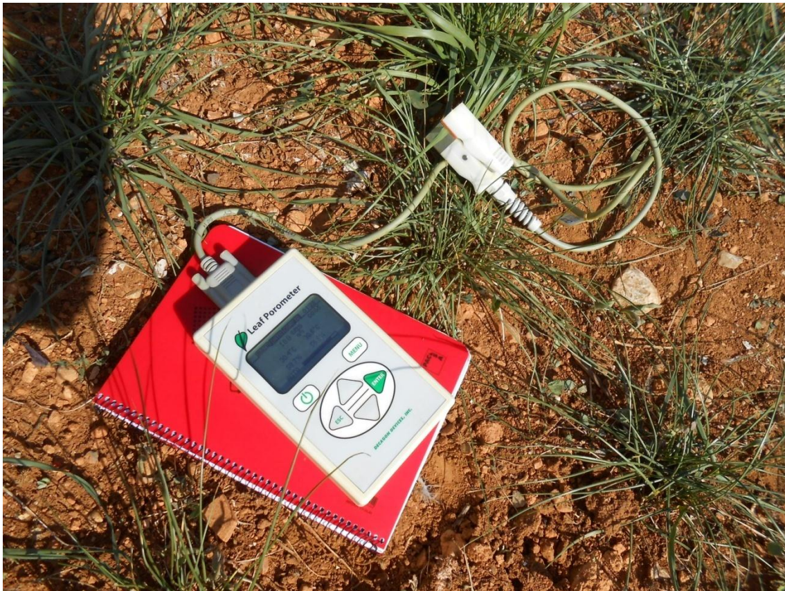
Figura 2. Mesura de transpiració en unitats de \text{mmol CO}_2/\text{m}^2\cdot\text{s} mitjançant poròmetre.
