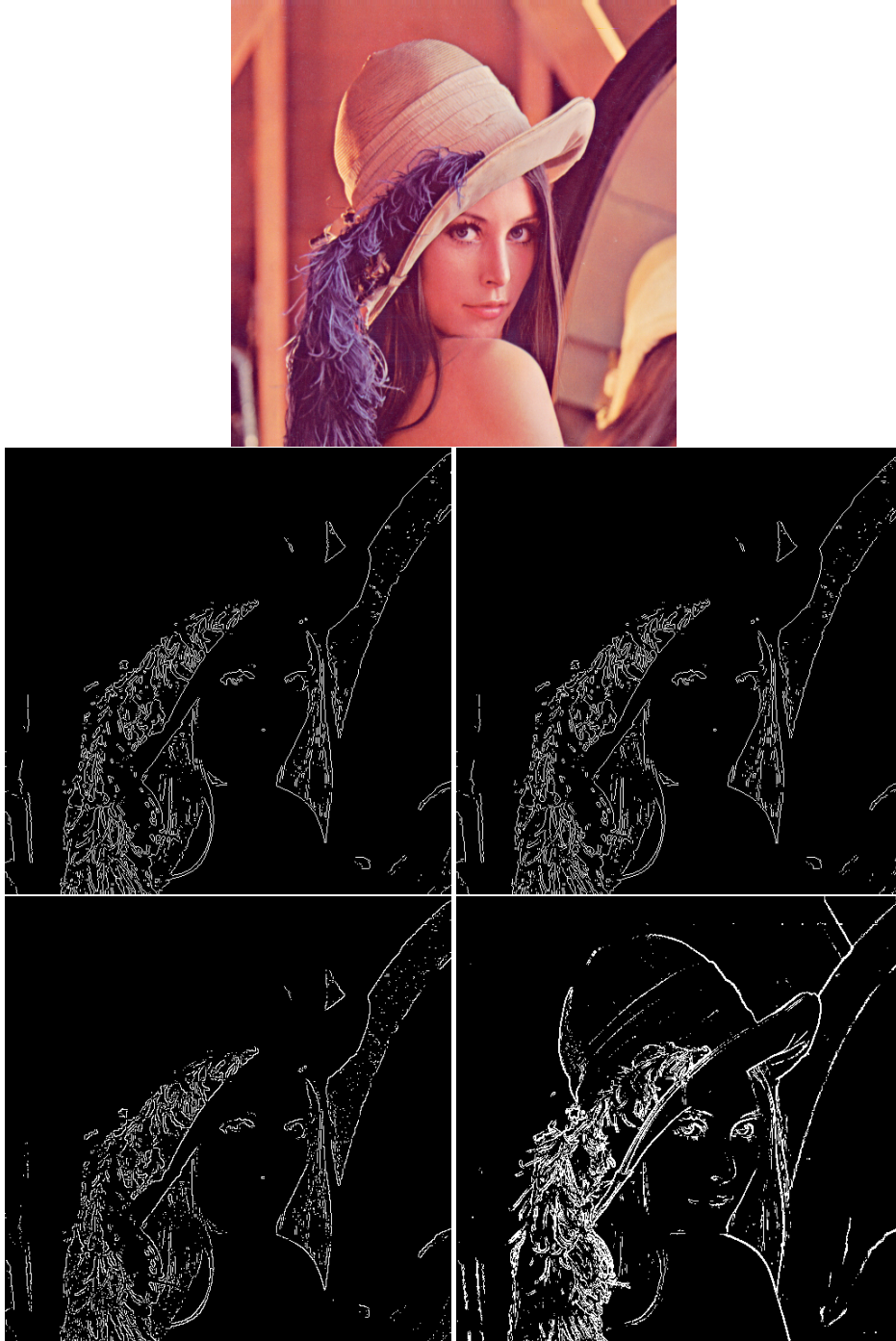
Figura 4.8: De izquierda a derecha y de arriba a abajo: imagen original y resultados del cálculo de gradiente con los operadores de Sobel, Prewitt, Roberts y gradiente bilineal.
