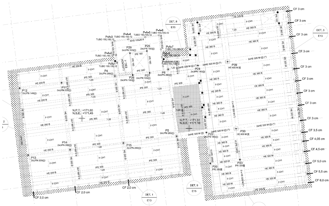
Figura 46. Vista de contraflechas en voladizos del proyecto ejecutado.
