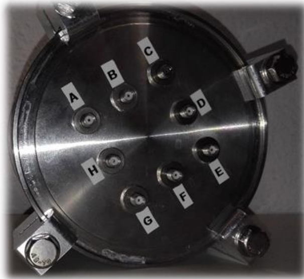
Ilustración 6: Vista inferior de la cámara hermética en la que puede apreciarse la salida al exterior de los conectores SMA.
