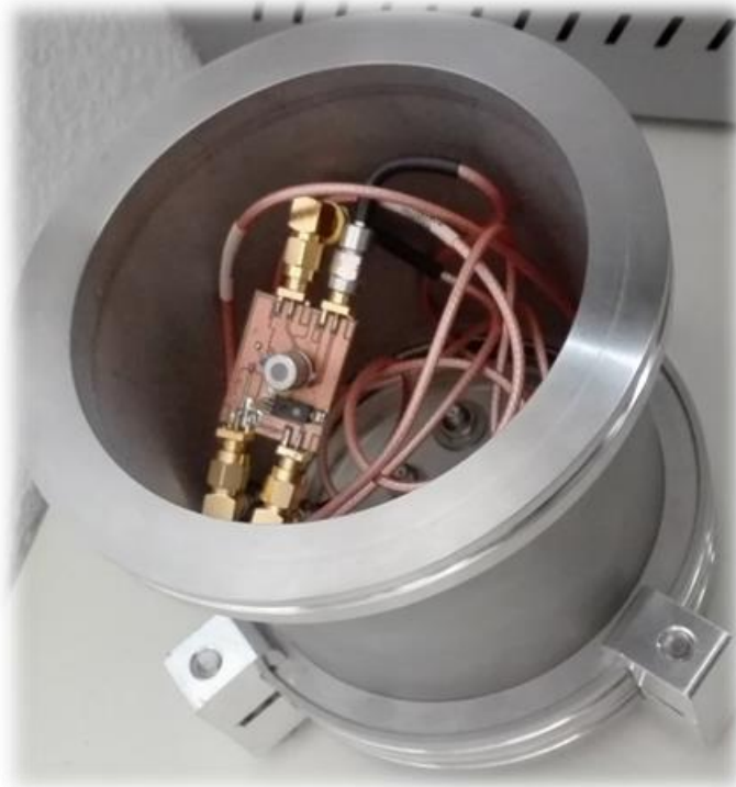
Ilustración 3: Cámara hermética con la PCB conectada a sus pasamuros SMA.
