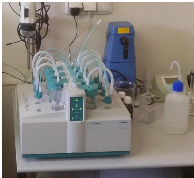
Ilustración 11. Equipo Rancimat utilizado en el cálculo del potencial oxidativo de las muestras de aceite (Fuente: propia).
