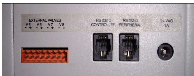
Figura 2.2. Conexiones situadas en la parte posterior de una bureta multijeringa. De izquierda a derecha: Salida para la conexión de hasta cuatro válvulas solenoides adicionales, conexiones RS232C (controlador y periférico) y conexión a la fuente de alimentación.
