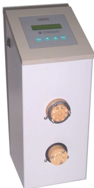
Figura 2.4. Módulo de válvulas mixto. Válvula de selección de 8 puertos en su parte superior. Válvula de inyección de 6 puertos y dos posiciones en su parte inferior.
