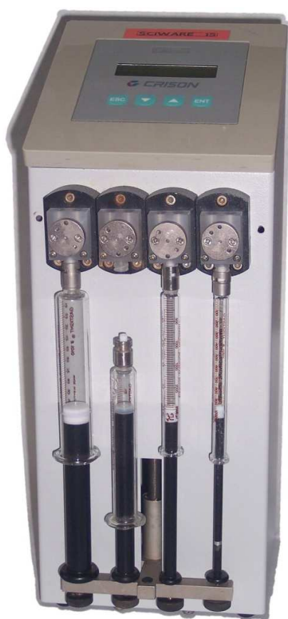
Figura 2.1. Bureta multijeringa equipada con jeringas de volumen igual a 10, 5, 2.5 y 1mL.
