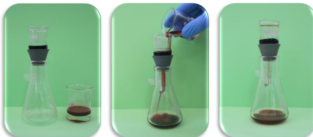
Figura 3.32. Sistema de filtració d'una mescla dodecà/aigua emprant com a filtre l'esponja MFS-c-MIL-100(Fe)-HCl. El dodecà es va tenyir amb Oil Red O per a una millor visualització.
