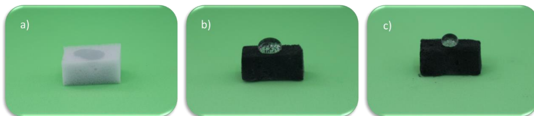
Figura 3.25. Imatges d'una gota d'aigua sobre les diferents esponges: a) MFS, b) MFS-c-ZIF-67-HCl i c) MFS-c-MIL-100(Fe)-HCl.
