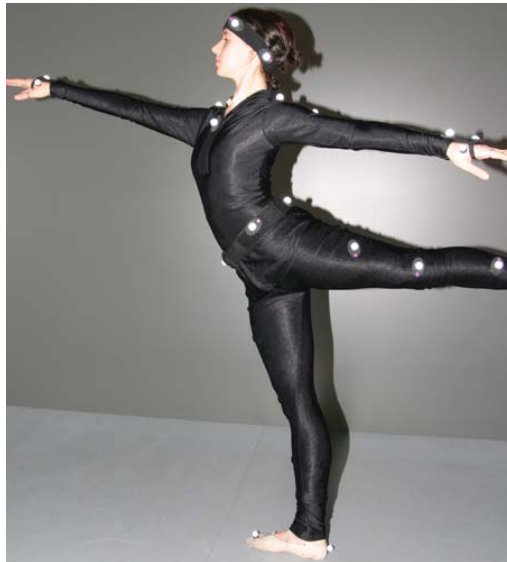
Figura 2.3: Sistema de captura del moviment humà que utilitza marcadors retro-reflectius.
