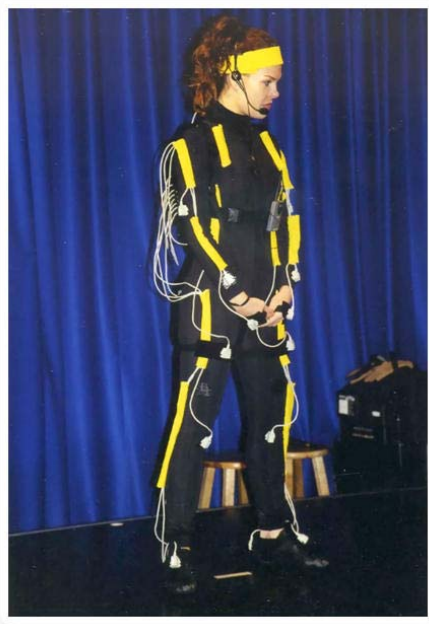
Figura 2.2: Sistema de captura del moviment humà que utilitza sensors magnètics.
