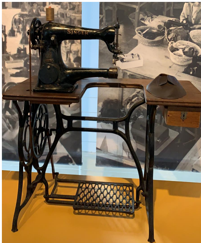
Imatge 5: Màquina de repuntar dins la secció d'enfranquiment. Imatge pròpia del Museu d'Inca, març 2019
