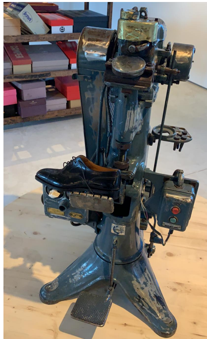
Imatge 10: Màquina per marcar punt. Imatge pròpia del Museu d'Inca, març 2019
