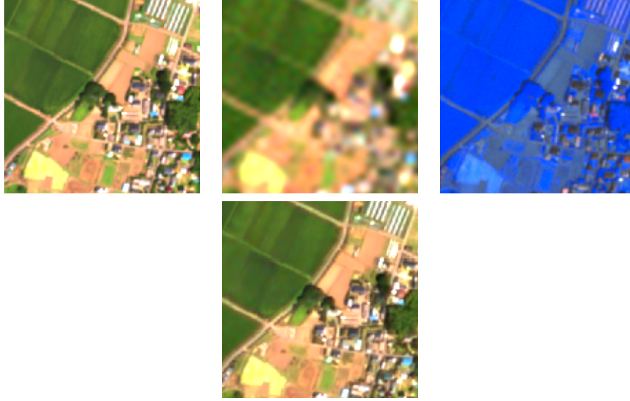
Figure 2: Évaluation visuelle des performances de la fusion HS-MS avec le gradient nonlocal sur l'image Chikusei 304 \times 304 \times 93 . De haut à gauche vers la droite. L'image référence, l'image HS, l'image MS et le résultat de la méthode proposée.
