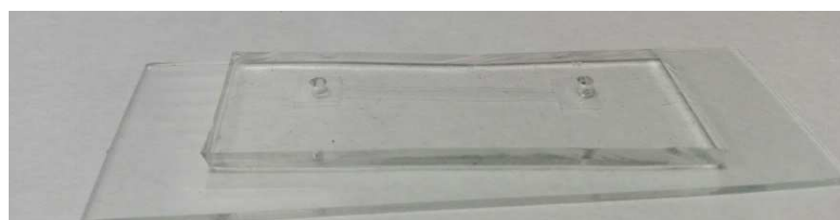
Fig. 7. Cel·la acabada. Mentre que la cel·la té una altura aproximada de 2 mm, el canal fa 0.06 mm aproximadament.
