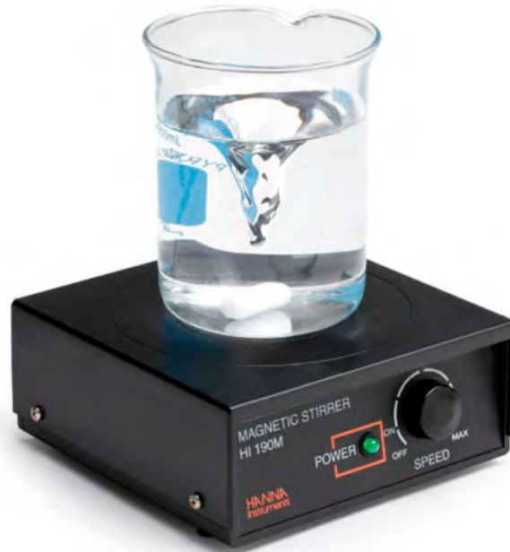
Figura 3.10: Agitador magnètic de Hanna Instruments [29]
