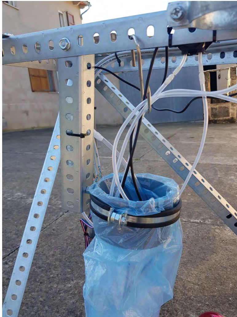
Figura 5.3: Detall del sistema de subjecció de la cavitat gàstrica.
