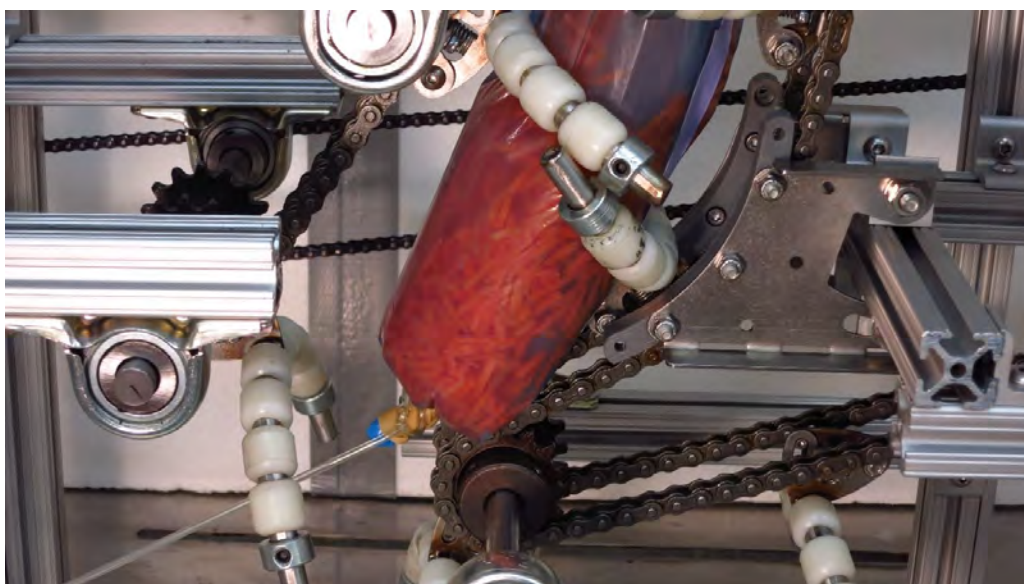
Figura 3.23: Detall de la cavitat gàstrica del HGS v.2 en ple peristaltisme. Imatge cedida per la UC Davis.
