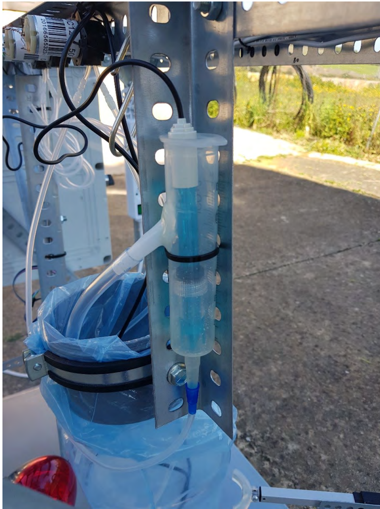
Figura 5.13: Dispositiu de mostreig de pH amb sortida per gravitació.
