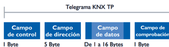
Figura 3.12: Estructura del telegrama en KNX TP.
