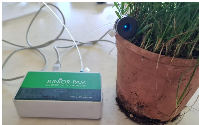
Figura 6: Monitoreo de P_p con el fluorímetro JUNIOR-PAM.
