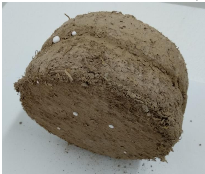
Ilustración 24. Muestra para ensayo en caja natural de plancha caliente de barro-paja. Imagen propia.
