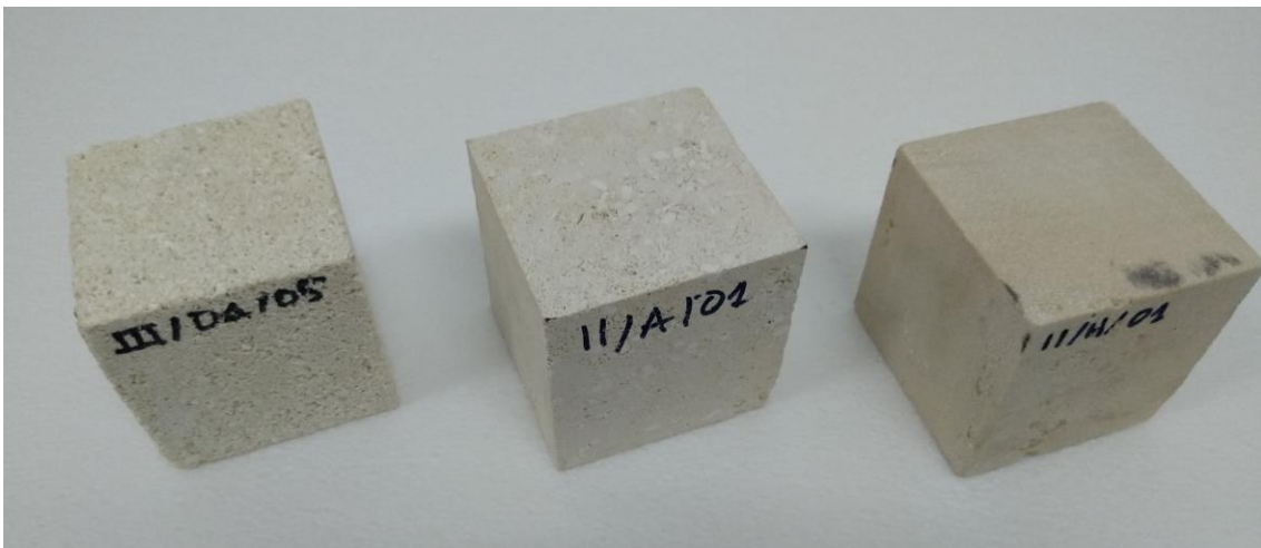
Ilustración 23. Muestras para ensayo en caja natural de plancha caliente de marés proveniente de canteras mallorquinas. Imagen propia.
