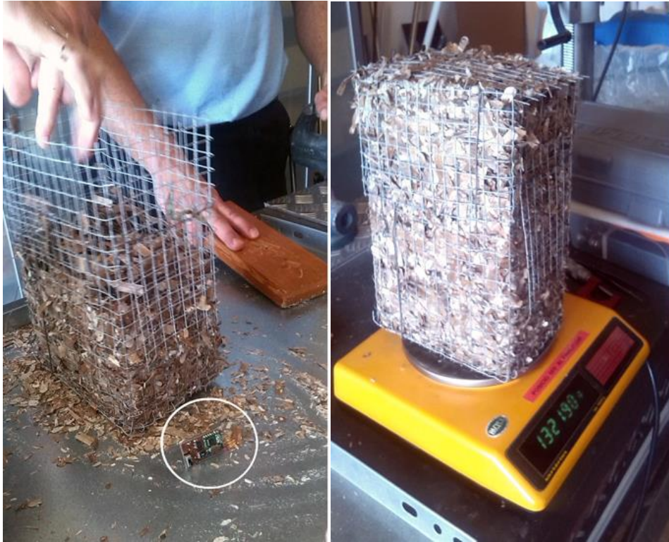
Ilustración 29. Sensor térmico introducido en muestra de posidonia oceánica compactada. Imagen propia.
