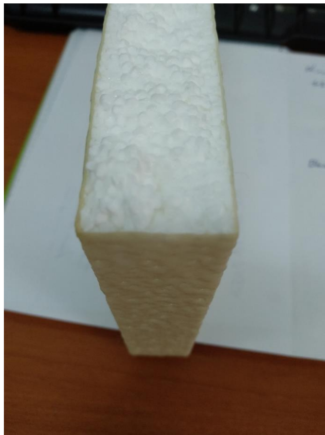
Ilustración 15. Sección pared caja natural, recubrimiento poliuretano y núcleo poliestireno expandido. Imagen propia.
