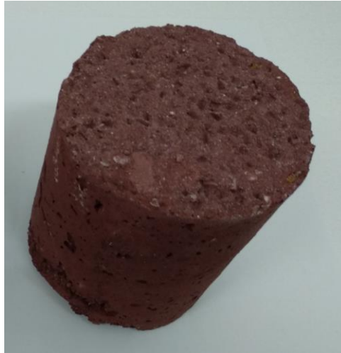
Ilustración 26. Muestra mortero de cal con aditivo \text{Fe}_2\text{O}_3 del 20%. Imagen propia.
