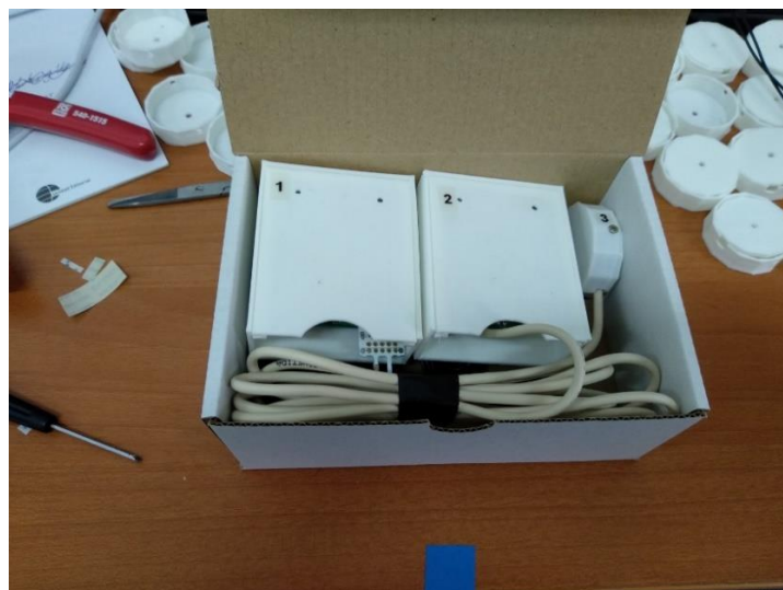
Ilustración 40. Instrumento Breeze, 1) elemento exterior de caracterización, 2) elemento interior de caracterización, 3) módulo de información al usuario.
