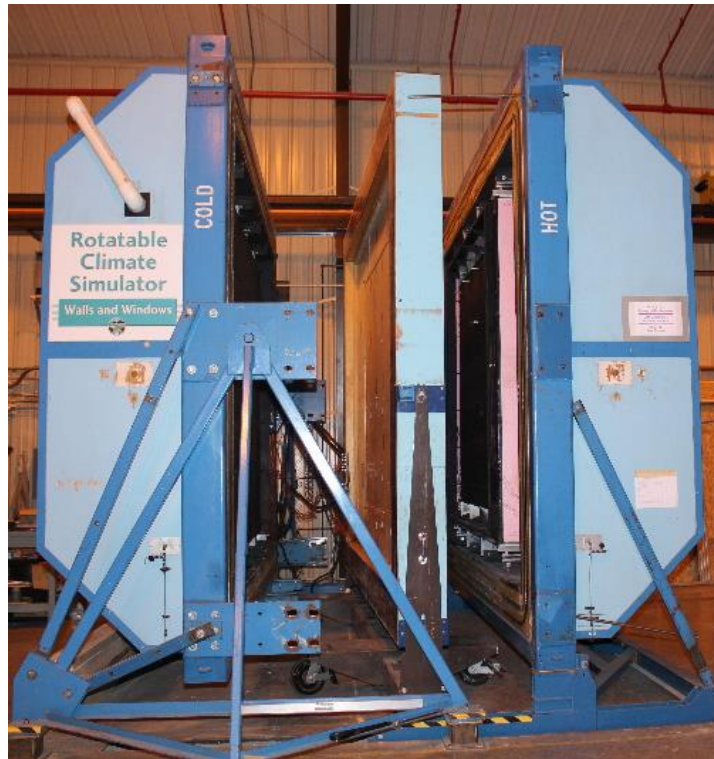
Ilustración 5. Instrumento caja caliente para la caracterización térmica de muros y ventanas. Imagen propiedad de Oak Ridge National Laboratory.
