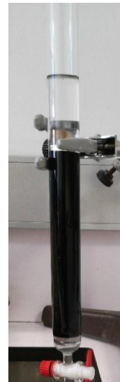
Figura. 4.2. Columna cromatográfica con la resina de intercambio en su interior.
