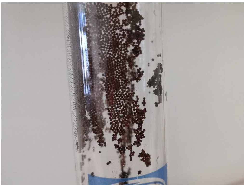
Figura. 5.1. Granos de resina Lewattit MonoPlus S108 en la columna cromatográfica.
