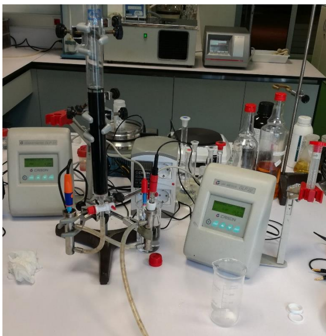
Figura.4.19. Montaje para la determinación en continuo del pH y la conductividad del vino a la salida de la columna.
