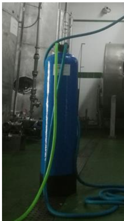
Figura 4.27. Columna de intercambio realizando el ensayo de punto de ruptura.
