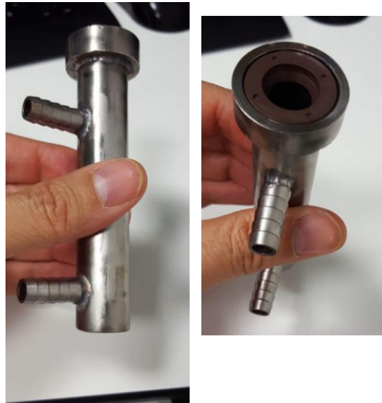
Figura. 4.6. Adaptadores de sondas de conductividad y pH para la experimentación en continuo.
