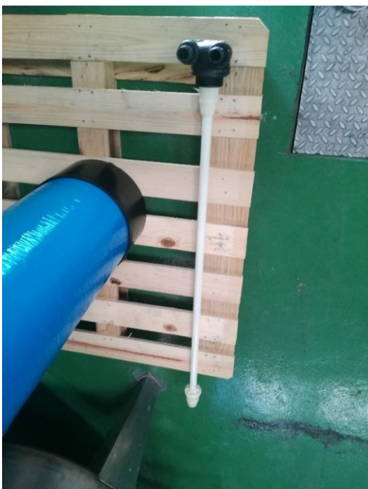
Figura. 4.24. Unión de la crepina de la valvula clack al tubo distribuidor.
