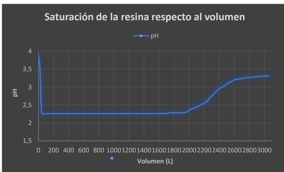
Figura 5.6. Saturación de la resina con vino blanco. Experimento con la columna de intercambio catiónico a escala pre-industrial.
