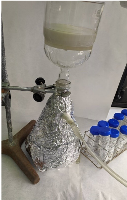
Il·lustració 5. A l'esquerra, filtració al buit de l'oli de gira-sol. A la dreta, comparació de l'oli purificat enfront a l'oli sense purificar.
