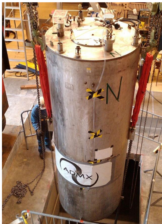
Fig. 14. Instal·lació de l'imant ADMX en la Universitat de Washington.
