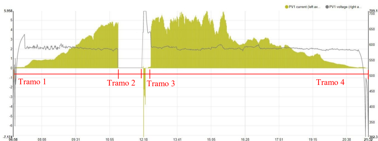
Fig. 3. Gráfica I (barras verdes con eje vertical a la izquierda) – V (línea negra con eje vertical a la derecha) de los paneles objeto de estudio durante una jornada, obtenida a partir de la monitorización del inversor.
