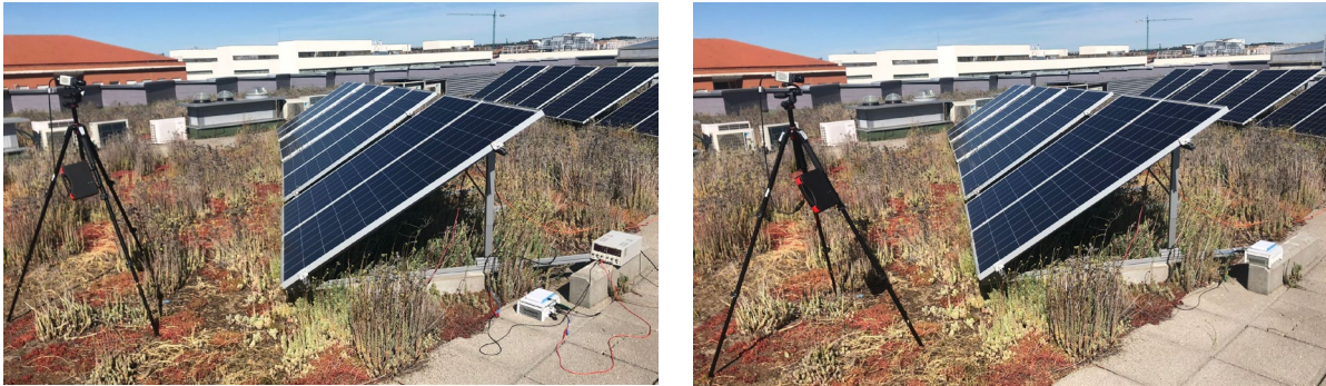
Fig. 4. Realización de las medidas de EL con polarización mediante la fuente de alimentación (izq.) y mediante el inversor bidireccional (dcha.)
