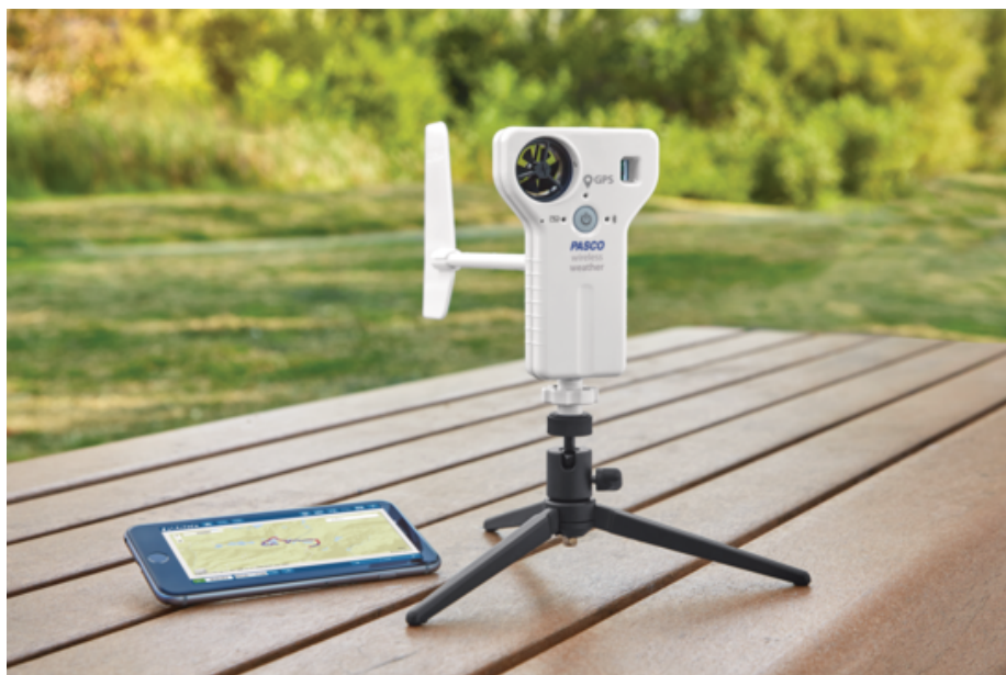
Figura A. 1.: Esquema de la EM Pasco wireless weather amb l'anemòmetre incorporat.
