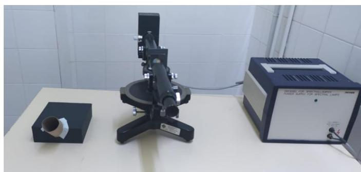
*Imagen Anexo 4.6. Espectroscopio casero (izq.) espectroscopio comercial (drcho.)*
