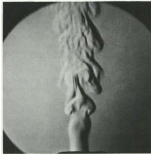
Ilustración 11. Chorro inestable de un gas (helio) que se escapa al aire ambiente (Merzkirch, 1987b)
