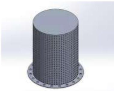
Ilustración 89. Vista isométrica del baffle
