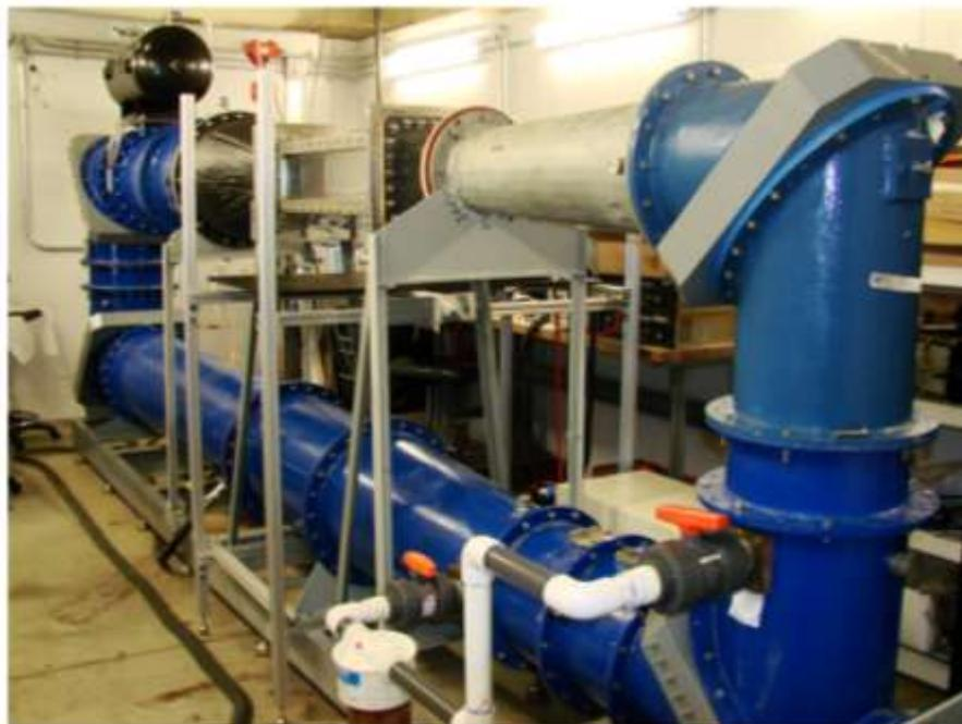
Ilustración 6. Túnel de agua de sección circular (Nedyalkov, 2012)
