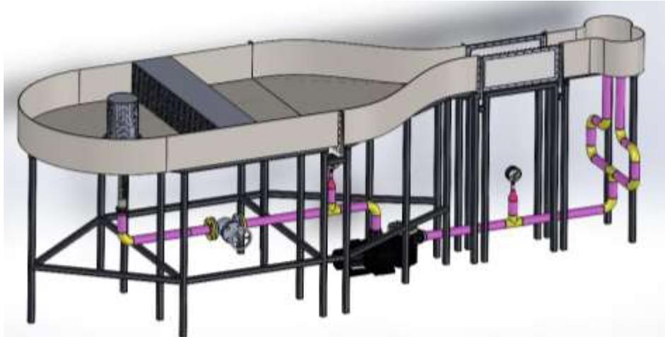
Ilustración 94. Esquema del túnel de agua ensamblado, incluida la estructura de soporte propuesta. La estructura soporte está compuesta por tubos de acero 1020 de sección cuadrada 40x40x4 mm. Los tubos se unen mediante soldadura. Los pilares y la bomba están anclados y sujetos al suelo.
