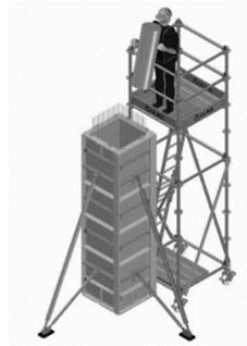
Figura 19.1: (1) Plataforma de trabajo y hormigonado de pilar.
