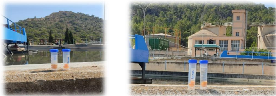
Figura 15. Extracción de THMs in-situ en una estación depuradora de aguas residuales (EDAR, Calviá 2000).
