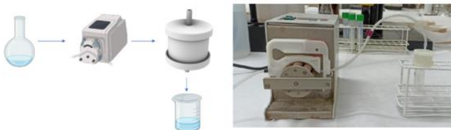
Figura 28 Diagrama e imagen de dispositivo adaptado a sistema de bombeo preliminar. Uso de bomba peristáltica dentro del laboratorio.
