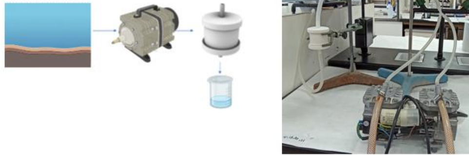
Figura 29 Sistema de extracción para estudio en campo. Empleo en campo de una bomba de pulsos a un caudal de 2.5 \text{ L min}^{-1} .
