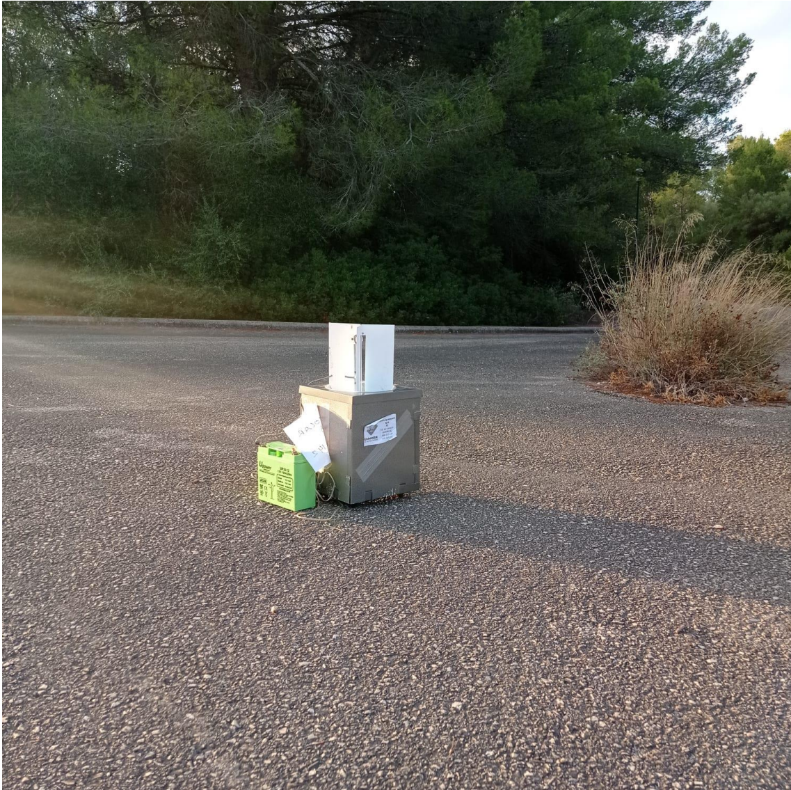
Figura 10. Trampa de luz para la captura de adultos (Marratxi, Mallorca). Autora: A. Rodríguez
