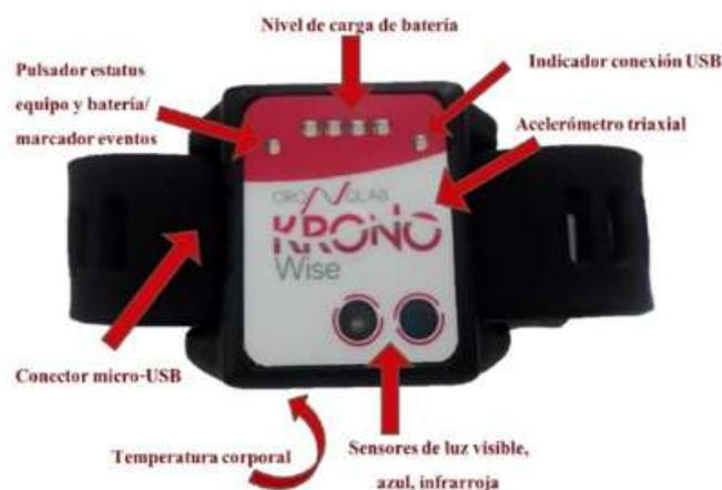
*Figura 10. Dispositivo Kronowise KW6. Fuente propia*
