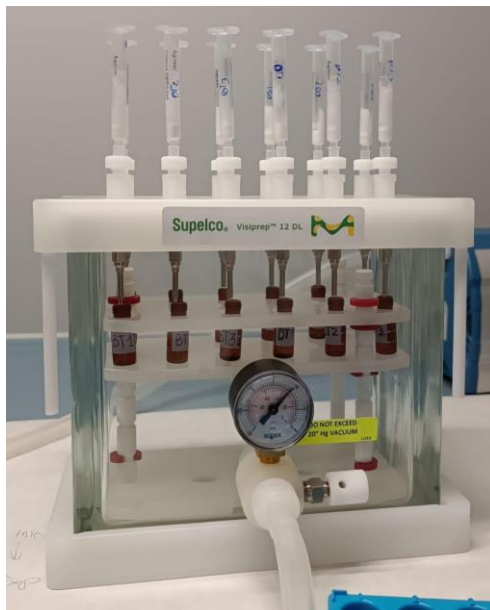
Figura 4. Màquina Visiprep amb les columnes de filtració a sobre i les guies a l'interior.
