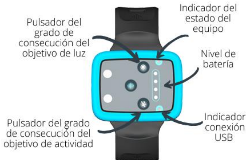
Figura 3. Dispositivo Kronowise KW6. Extraído de Kronohealth.
