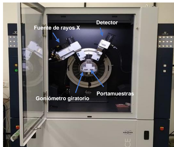
Figura I. 3. Interior de un difractómetro de polvo en el que se muestran las diferentes partes.
