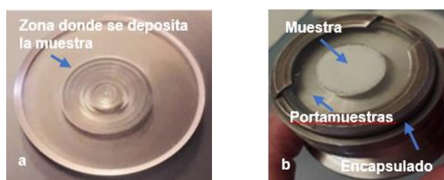
Figura III. 2. En la figura a se observa el portamuestras, mientras que en la figura b , la muestra adherida al encapsulado que va en el centro del difractómetro.
