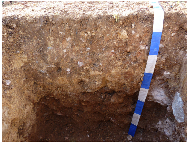
Figura 4: Imagen del perfil edáfico del suelo a estudiar. La longitud de cada banda de color es de 10 cm
