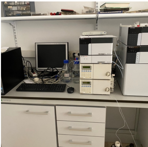
Fotografía 15. HPLC empleado para la puesta a punto de los ensayos cromatográficos necesarios para la determinación de la composición de los extractos.
