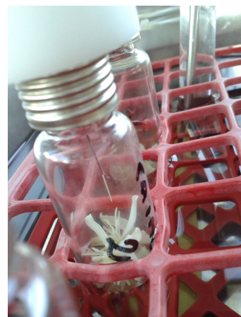
Figura 7. Vial al baño maría que contiene una flor de C. flammula y un pincel PDMS/DVB.
