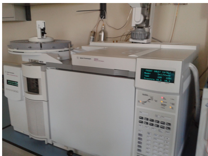
Figura 8. Cromatógrafo de gases acoplado a un espectrómetro de masas (GC-MS). Agilent 6890 N.
