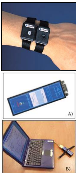
Fig. 9. A) Lector de los datos recopilados en el activímetro. B) Conexión Pc-reader-actiwatch.
