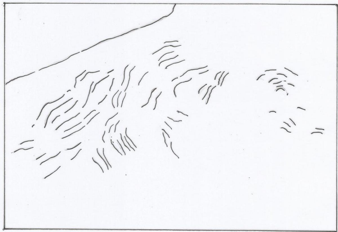
Esquema Imatge 63: S'observen les margocalcàries molt plegades i slumpitzades com a conseqüència de desplaçaments gravitacionals
