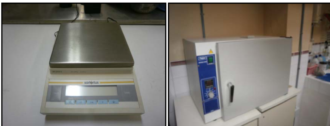
Figura 48: Imatges del instrumental utilitzat en laboratori. A la imatge esquerra la bàscula de precisió (error 0.01 g) per al pes de cada una de les mostres inicials, i de les fraccions granulomètriques derivades. A la dreta es mostra l'estufa de dessecació per eliminar el grau d'humitat de les mostres recollides al camp.
