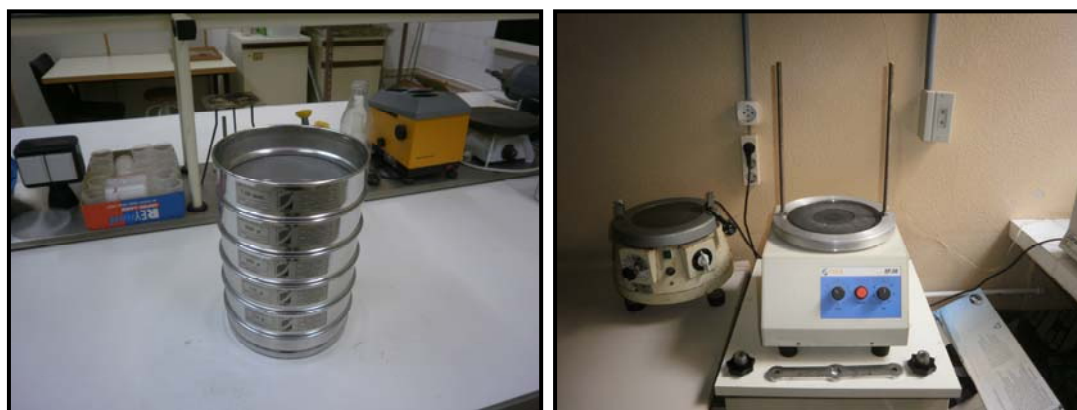
Figura 49: A l'esquerra es veu la pila de tamisos utilitzada per separar les fraccions granulomètriques del sediment analitzat, mentre que la imatge de la dreta mostra la tamisadora electromagnètica utilitzada per accelerar el procés de separació.
