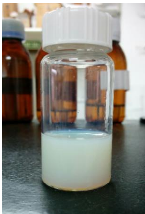
Figura 9. Dispersió de ZnO en la mescla de polimerització.
