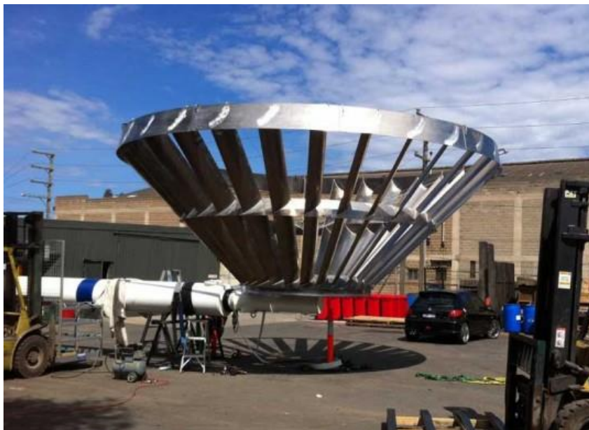
Fotografía 1. Aerogenerador especialmente diseñado para la disminución del ruido y el impacto aviar. Fuente: http://www.medioambiente.org/2011/11/aerogenerador-silencioso.html
