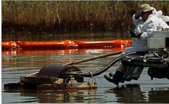
Fotografía 3. Recuperación de aceites mediante un skimmer de tambor.
