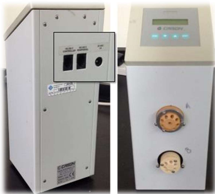
Figura 4.4. Imagen correspondiente a un módulo de válvulas mixto. Izquierda: parte posterior del dispositivo que muestra las conexiones hacia otros instrumentos. Derecha: parte frontal del módulo. Válvula de selección en su parte superior y válvula de inyección en su parte inferior.
