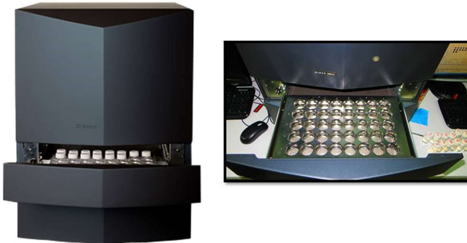
Figura 2.15. Fotografía del detector de centelleo líquido Hidex 300SL. A la derecha imagen de su bandeja para 40 viales de 25 mL de capacidad.
